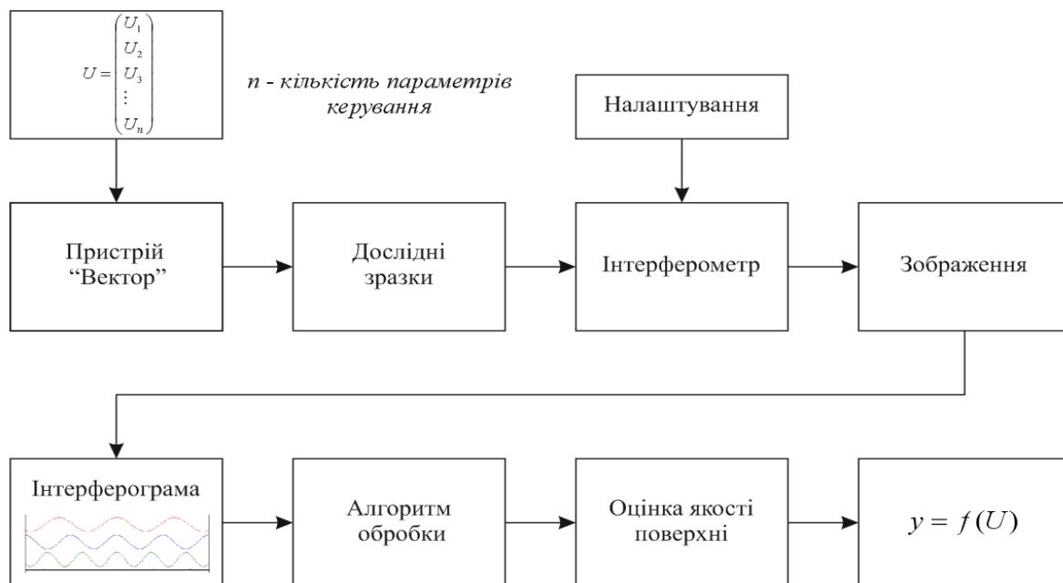
Рис. 4. – Структурна схема етапів контролю якості пластин
