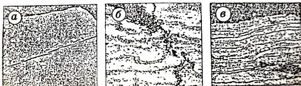
Рис. 4. Трещина ВИР (а,  $\times 25$ ), СКРН(б,  $\times 175$ ) и поверхностное вздутие (в,  $\times 125$ ) металла при испытании обсадных труб из сталей Р-100
